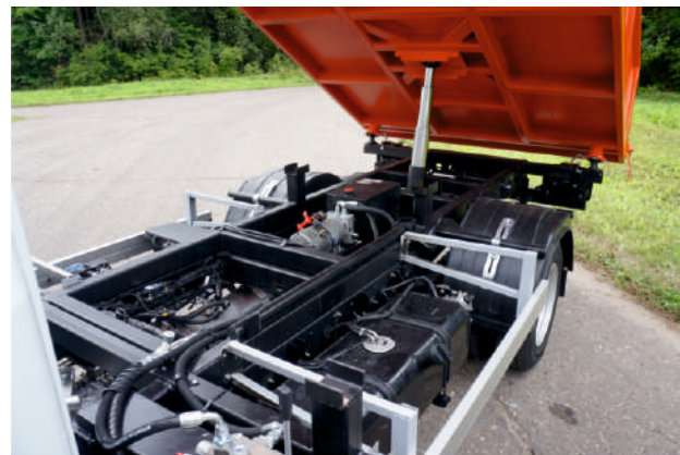
Гидравлический привод осуществляется от гидронасоса, приводимого в действие от коробки отбора мощности.
