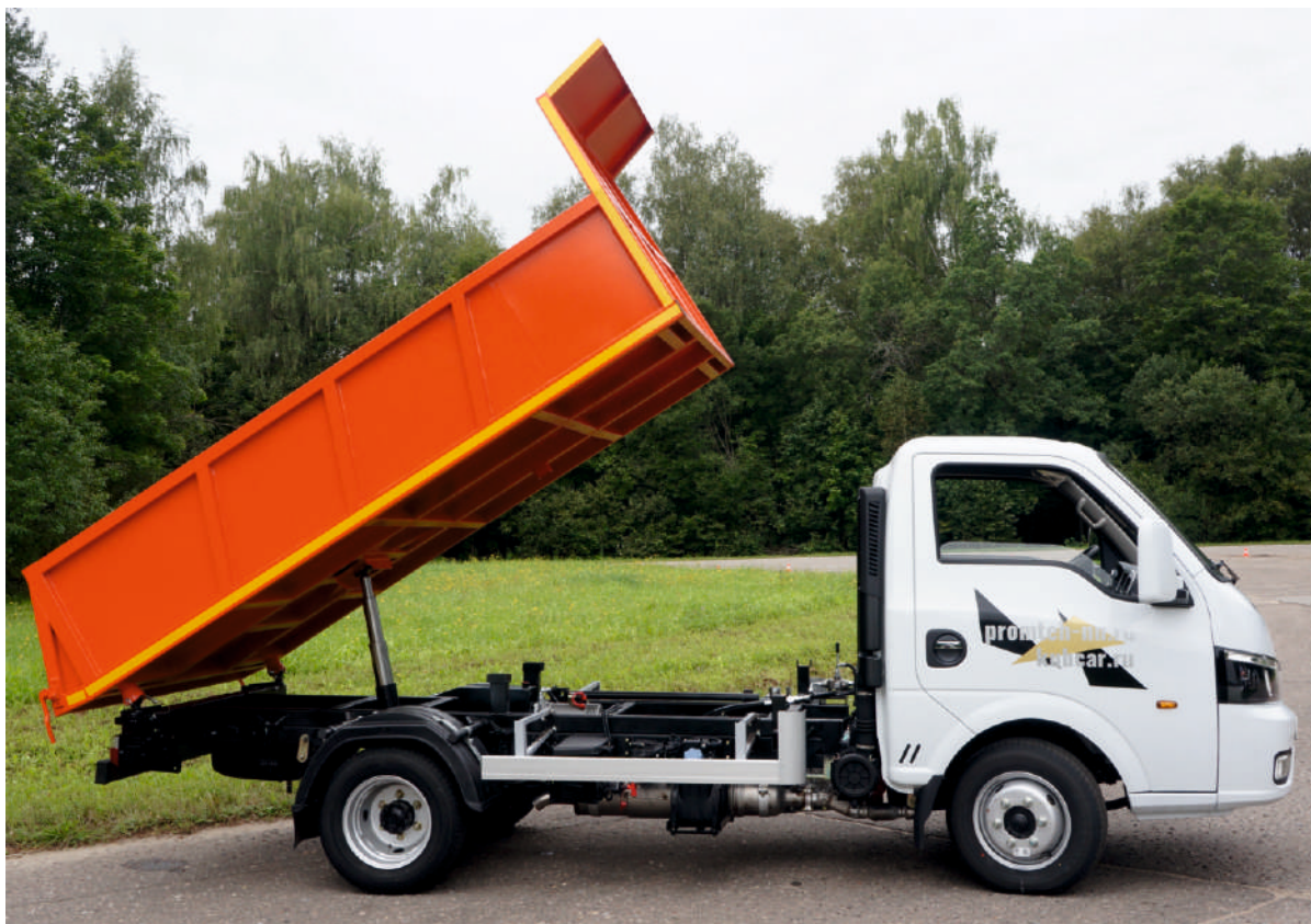
Колесная база 2800 мм, кузов 3х2 метра, высота борта 0,6 метра. Задняя разгрузка.
