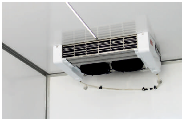
Установка мощностью 2кВт. Температура внутри фургона от -20 до +12 °С при 30 градусах жары.
