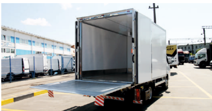
Грузоподъемность гидроборта 750 кг
