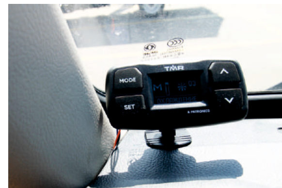
Датчик температуры холодильного фургона в кабине водителя
