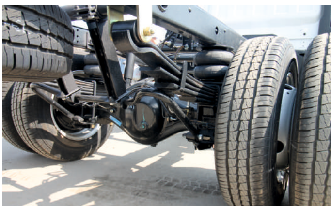
Стабилизатор поперечной устойчивости задней оси, рессоры дополнены пневматическими элементами.
