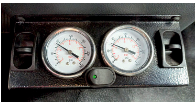
Раздельная регулировка воздуха по правому и левому борту в пневмобаллонах.
