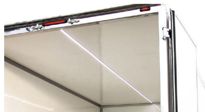
Освещение фургона светодиодами. Кнопка включения/выключения располагается в фургоне.
