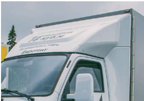
Обтекатель состоит из верхней и боковых деталей.
