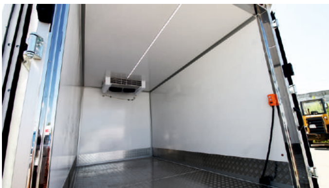
Толщина стен от 50 до 80 мм. Пол - рифленый алюминий толщиной 16 мм.
